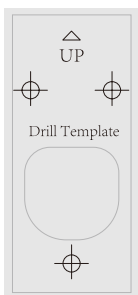
Boorsjabloon voor intercompaneel (x1)
